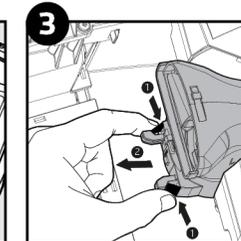
Pressez les 2 languettes conjointement pour retirer le collecteur d'échappement. Tirez-le vers la niche du panier filtrant.
