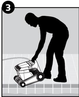
Plongez le robot nettoyeur à l'intérieur de la piscine. Relâchez-le pour qu'il descende jusqu'au fond de l'eau. Assurez-vous qu'il n'y a rien qui gêne le câble bleu.
